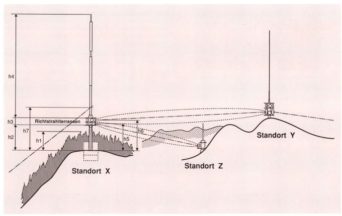
Fig. 5 Die Turmhöhe bestimmende Hauptfaktoren
