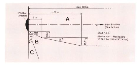
Fig. 4 Abstrahlfreiheit von Parabolantennen
