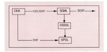
Fig. 8 Convergence entre ODA et SGML
