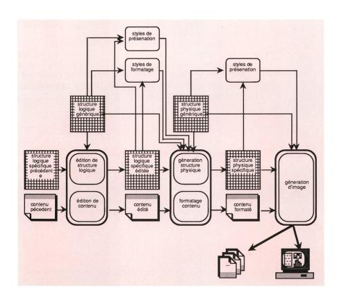
Fig. 5 Modèle de traitement d'un document
