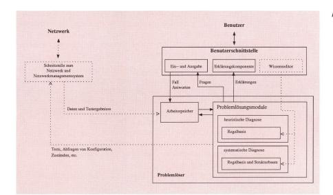
Fig. 1 Funktionales Schema des Prototyps Mail-Diagnostic
