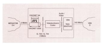
Fig. 3 Konfiguration des Übergangs zwischen dem deutschen VBN und dem Megacom-Netz (VBN = vermitteltes Breitband-Netz)
