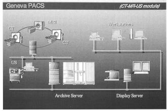
Fig. 4 Architektur eines PACS
