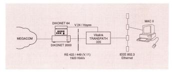
Fig. 11 Gerät und Schnittstellen am Megacom-Anschluss
