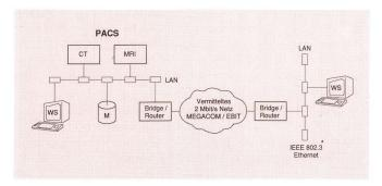
Fig. 10 Kommunikationskonfiguration für die digitale Bildübertragung im Telemed-Projekt
