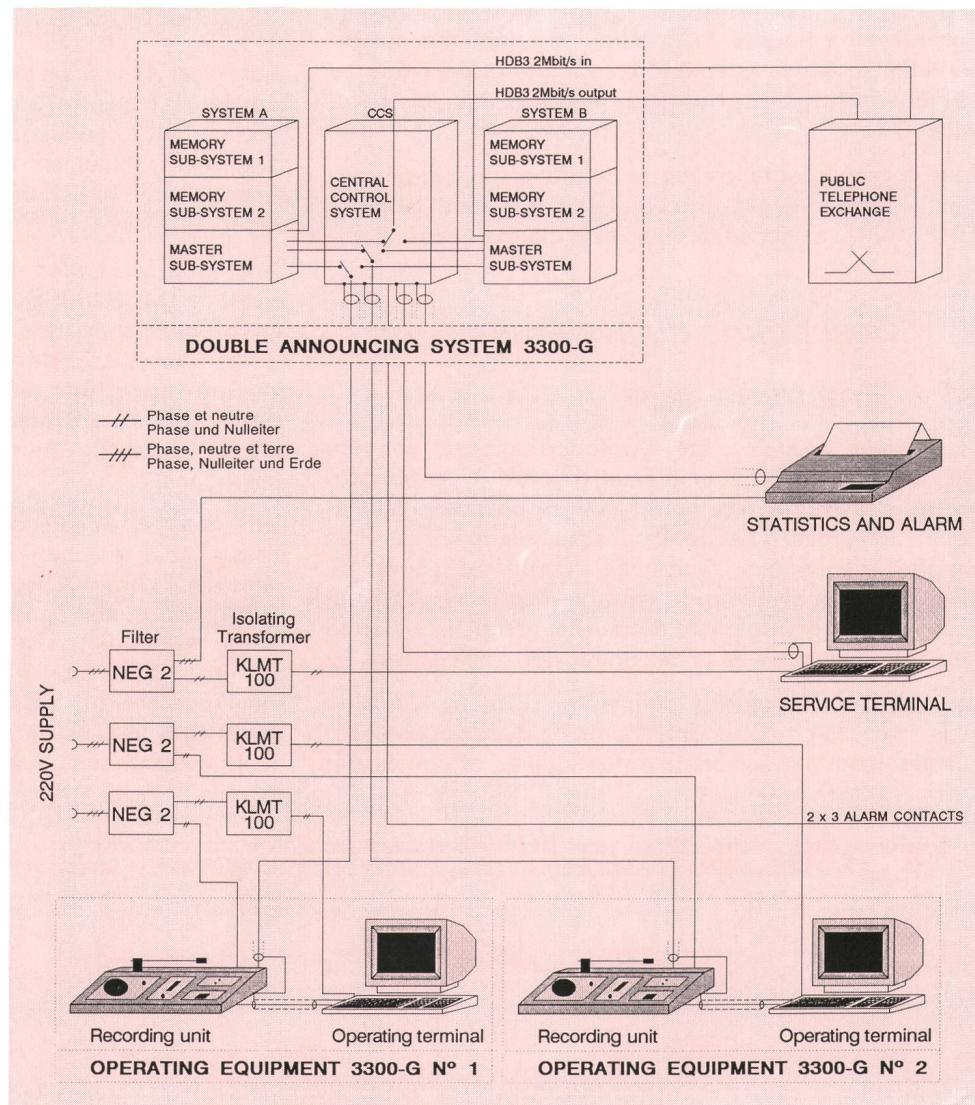
Fig. 1 Structure du système d'information multicanal – Struktur des Mehrkanal-Informationssystems
