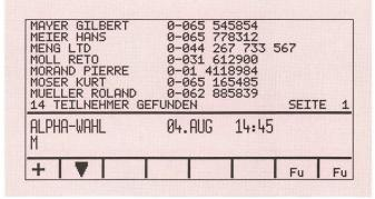
Fig. 5 Das eingebaute «Telefonbuch» im Ascotel Crystal ermöglicht der Telefonistin schnelle Verbindungsaufbauten
