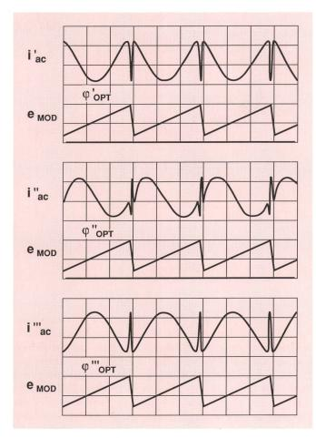
Fig. 7 Sägezahn-Phasenmodulation i'ac, i''ac, i'''ac Photodiodenstrom in verschiedenen Phasenlagen  $\phi'_{\text{opt}}, \phi''_{\text{opt}}, \phi'''_{\text{opt}}$ Optische Phase zwischen den beiden Wellen  $e_{\text{mod}}$  Modulationsspannung
