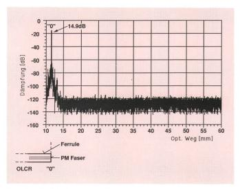
Fig. 8 OLCR-Ausgang, Referenzmessung
