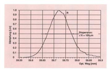
Fig. 14 Dispersion im LiNbO $_3$ -Wellenleiter Kanal H = 4  $\mu$ m B = 10  $\mu$ m
