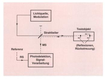
Fig. 1 Optisches Reflektometer, Grundschema
