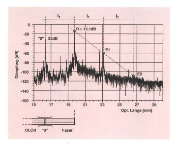
Fig. 10 Faser-Faser-Übergang (optischer Stecker)
