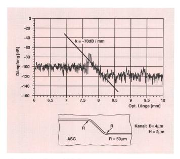
Fig. 17 Detail des ASG-Bogens aus Fig. 16
