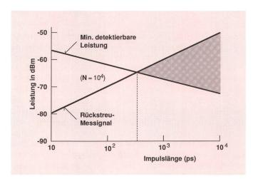
Fig. 3 Rückstreumesssignal und minimale detektierbare Leistung in einer Einmodenfaser bei direkter Detektion
