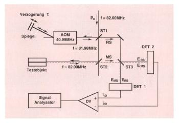
Fig. 4 Symmetrische Überlagerungsdetektion (Balanced Heterodyne Detection) ST1, ST2, ST3 Strahlteiler
