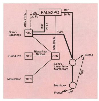
Fig. 1 Connection of the exibition building Palexpo to the telecommunications network – Raccordement de Palexpo au réseau de télécommunications
