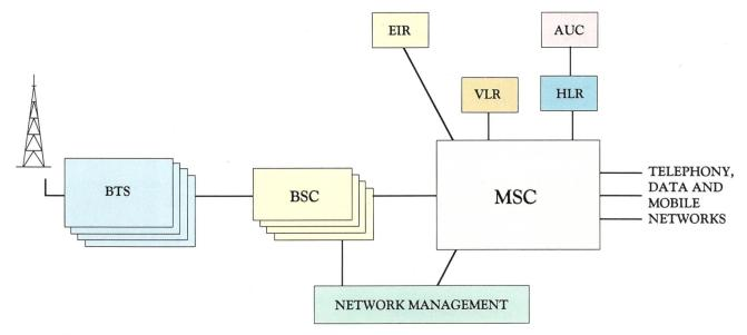
Fig. 2 GSM Network - Réseau GSM
