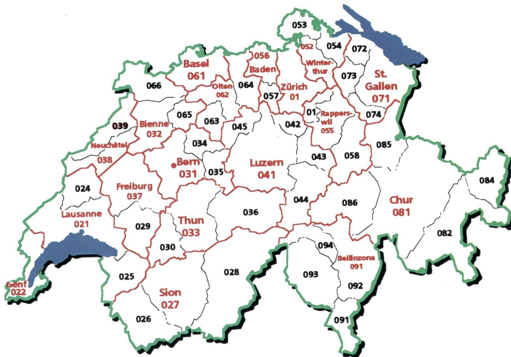
Fig. 8 Numbering plan – Plan de numérotation with 18 toll areas – avec 18 groupes de réseaux
