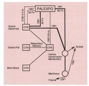
Fig. 1 Anschluss des Ausstellungsgebäudes Palexpo an das Fernmeldenetz – Allacciamento dell'edificio Palexpo alla rete delle telecomunicazioni
