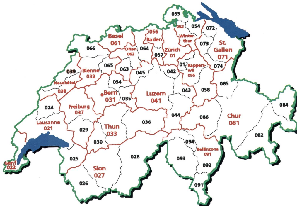
Fig. 8 Numerierungsplan – Piano di numerazione Numerierung mit 18 Netzgruppen – Numerazione con 18 gruppi di reti
