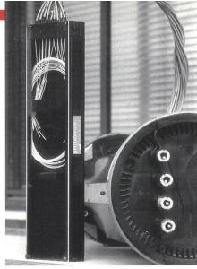
Fig. 6 Passiver optischer Verteiler Sein Herz besteht aus Schmelzkopplern, in denen zwei Fasern so verschmolzen werden, dass sich eine gleichmässige Aufteilung des Signals ergibt.
