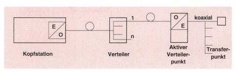
Fig. 3 Fibre to the Curb - Glasfaser vors Haus
