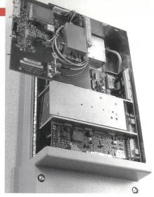
Fig. 8 Geöffnetes Netzabschlussgerät mit optischer Sendeund Empfangseinrichtung
