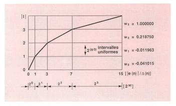
Fig. 3 Quantificateur à 7 segments pour  $qi \ge 3$  bits et  $1 \le i \le 4$
