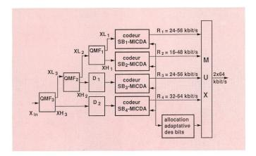
Fig. 5 Schéma de principe du codeur SB-MICDA
