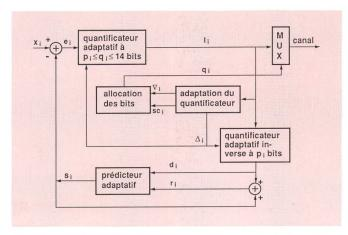
Fig. 2 Schéma de principe du codeur MICDA dans la SBi pour  $1 \le i \le 4$
