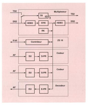
Fig. 6 Répartition des fonctions du système SB15
