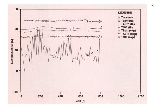
n. 3 Vergleich der experimentellen (exp) und berechneten (th) Temperaturen in der Telefonzentrale Birmensdorf ZH für den Zeitraum vom 22. 3. 1989 zum 25. 4. 1989
