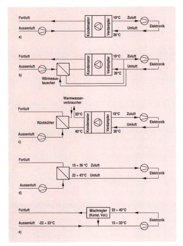
Fig. 8 Kühlungssysteme für Telefonzentralen
