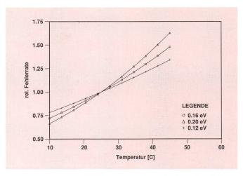
Fig. 7 Qualitative Abhängigkeit der relativen Ausfallrate einer Telefonzentrale von der Temperatur für eine Fehleraktivierungsenergie von 0.12, 0.16 bzw. 0.20 eV
