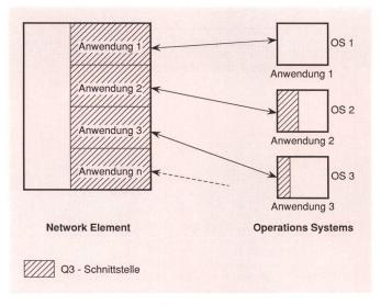
Fig. 2 Aufteilung der Q3-Schnittstelle zwischen Netzelement und Datenverarbeitungssystemen
