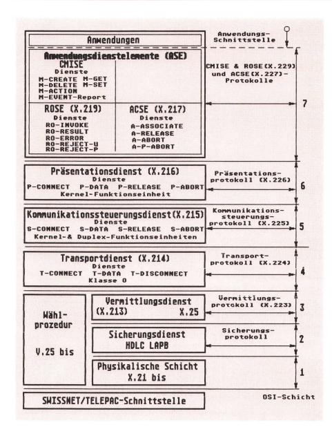
Fig. 3 Protokollsatz der PTT für Ω3-Schnittstellen
