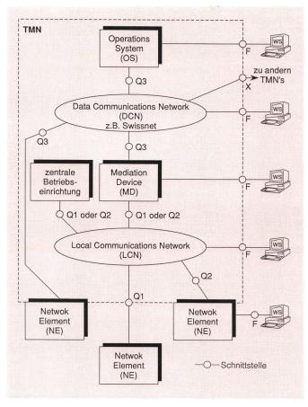
Fig. 1 Architektur eines Verwaltungsnetzes (TMN)
