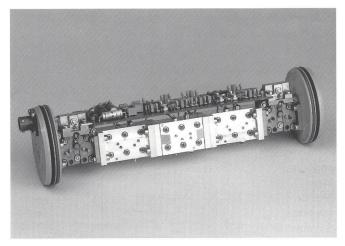
Fig. 5 Verstärker ohne Gehäuse
