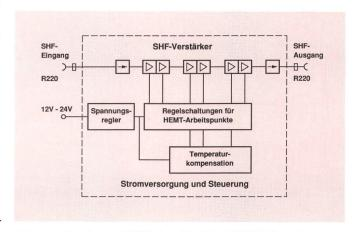
Fig. 1 Blockschaltbild des 20-GHz-HEMT-Verstärkers
