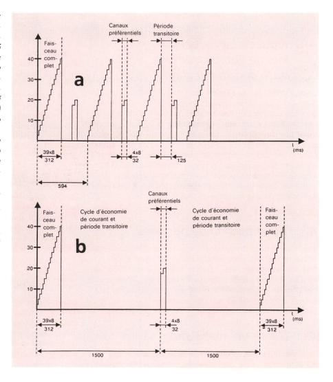
nués de moitié et que la consommation de courant moyenne est réduite. La répartition égale sur les deux faisceaux de canaux est assurée par une attribution continue du code d'identification, effectuée en usine. Pour diminuer le temps nécessaire à l'établissement de la communication on a défini, dans les 40 canaux et en fonction du code d'identification, huit faisceaux préférentiels de cinq canaux chacun.
