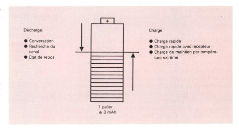
nuel peut également être appelé lorsqu'il est raccroché (même s'il se trouve sur un dispositif de charge éloigné de l'appareil de base), une part du courant est consommée par le récepteur durant la charge rapide. Toutefois, cet état de fonctionnement est pris en considération par le compteur d'état de charge.
