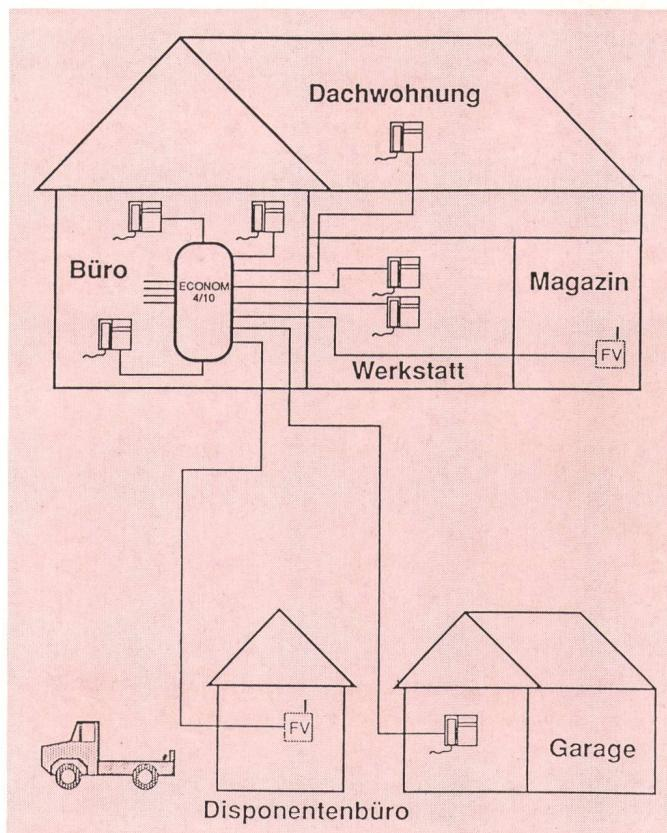
Fig. 1 Die Teilnehmervermittlungsanlage ECONOM 4/10 als Kommunikationssystem in einer Bau-firma. Das grossflächige Betriebsareal und die Mobilität der Mitarbeiter erfordern, dass drahtlose wie drahtgebundene Telefonapparate ange-schlossen werden können
