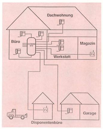
Fig. 1 Die Teilnehmervermittlungsanlage ECONOM 4/10 als Kommunikationssystem in einer Baufirma. Das grossflächige Betriebsareal und die Mobilität der Mitarbeiter erfordern, dass drahtlose wie drahtgebundene Telefonapparate angeschlossen werden können
