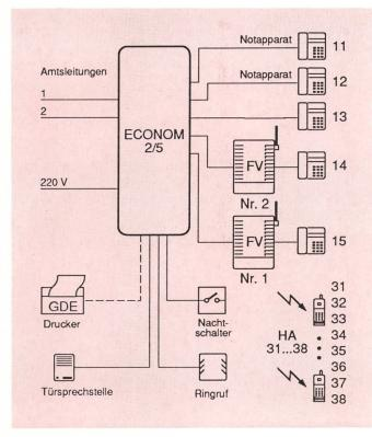
Fig. 3 Anschlussmöglichkeiten der Teilnehmervermittlungsanlage ECONOM 2/5
