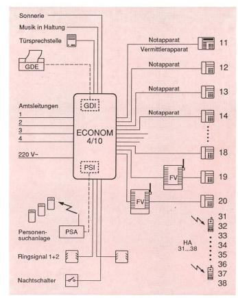
Fig. 4 Anschlussmöglichkeiten der Teilnehmervermittlungsanlage ECONOM 4/10
