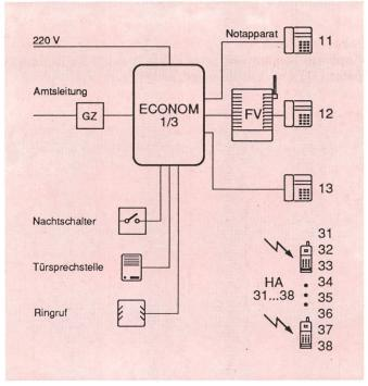
Fig. 2 Anschlussmöglichkeiten der Teilnehmervermittlungsanlage ECONOM 1/3
