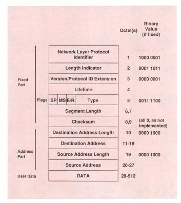
Fig. 7 Aufbau einer Datenprotokoll-Dateneinheit (DT PDU, ISO 8473)
