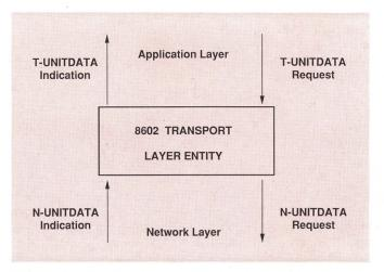
Fig. 6 Service Interfaces Transport Layer – Dienstschnittstellen der Transportschicht
