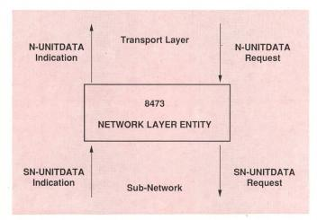
Fig. 9 Service Interfaces Network Layer – Dienstschnittstellen der Vermittlungsschicht
