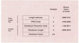
Fig. 5 Aufbau einer Transportprotokoll-Dateneinheit (TPDU, ISO 8602)
