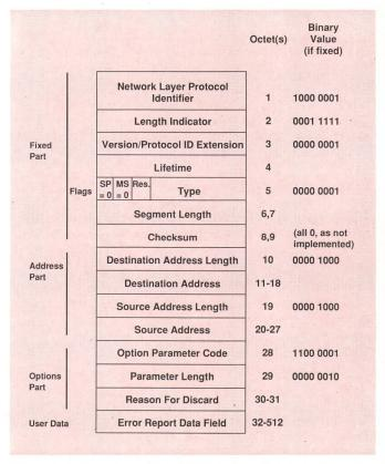
Fig. 8 Aufbau einer Fehlerprotokoll-Dateneinheit (ER PDU, ISO 8473)
