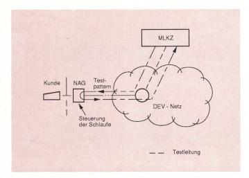
Fig. 8 Messschlaufe zum Kunden
