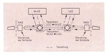
Fig. 9 Streckenmessung auf internationalen Mietleitungen («Butterfly Test»)
