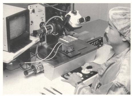
Fig. 2 Herstellung von Hybridschaltungen bei Siemens-Albis AG in Zürich. Die extrem hohen Anforderungen an die Positioniergenauigkeit bedingen trotz der Steuerung mit einem elektronischen System die ständige Überwachung durch qualifizierte Mitarbeiter
