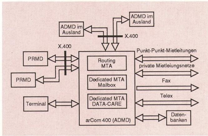
Fig. 1 Systemaufbau – Configuration du système
