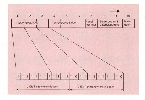
Fig. 4 Telegrammaufbau
