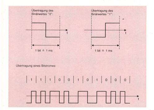
Fig. 3 Prinzip der Phasenmodulation
