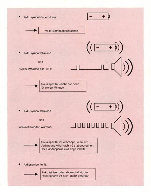
Fig. 6 Akkumulator-Betriebszustände des Handapparats
