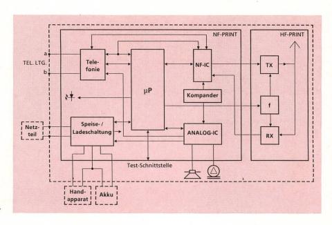
Fig. 7 Blockschaltbild Basisapparat
