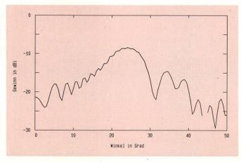
Fig. 4 Fernfeldstrahlungscharakteristik der Erreger/ Subreflektoreinheit
