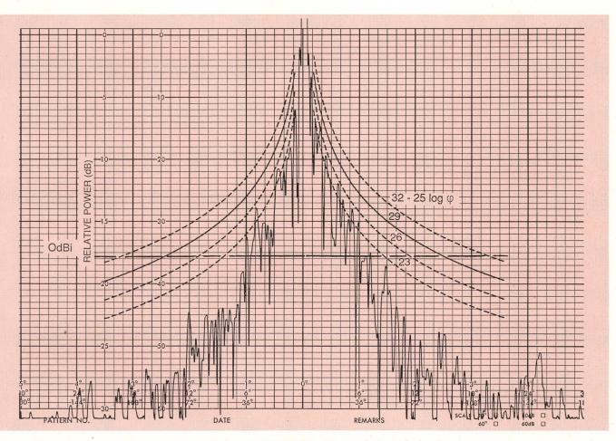
Fig. 7a Gemessene Strahlungscharakteristiken bei 29,75 GHz für vertikale Polarisation
