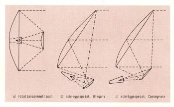
Fig. 1 Doppelreflektorsysteme
