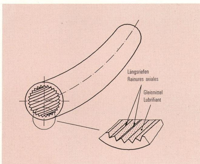
Fig. 1 Kunststoffrohr mit Rillen und Gleitmittel – Tube de matière plastique avec rainures et lubrifiant
