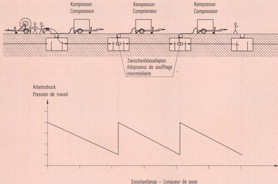
*Fig. 9 Arbeiten mit Zwischenblas-Adapter – Travail avec l'adaptateur de soufflage additionnel*
