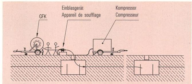
*Fig. 8 Einblasdisposition – Disposition des appareils pour le soufflage*
