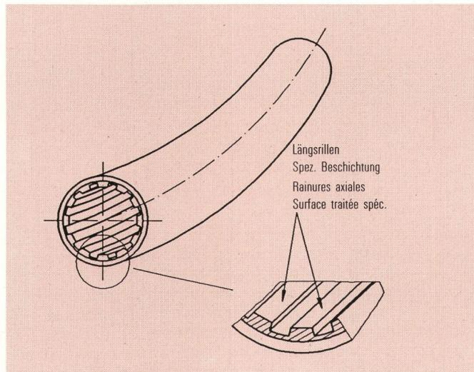
Fig. 2 Rohr mit Spezialbeschichtung – Tube avec revêtement spécial
