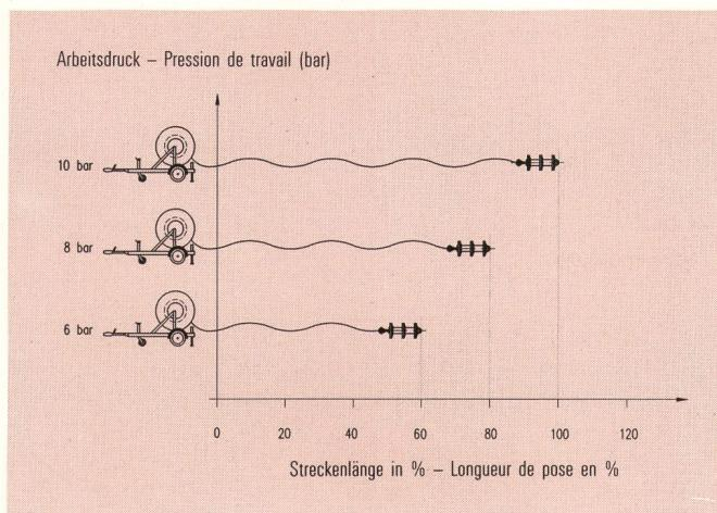
**Fig. 5 Einblasstrecke in Abhängigkeit des Arbeitsdrucks – Distance de soufflage en fonction de la pression de travail**
