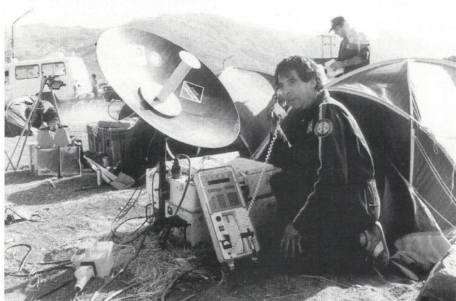
**Fig. 6 Equipment INMARSAT A transportable pour utilisation mobile dans le terrain – Un impianto INMARSAT trasportabile per l'impiego mobile terrestre**
