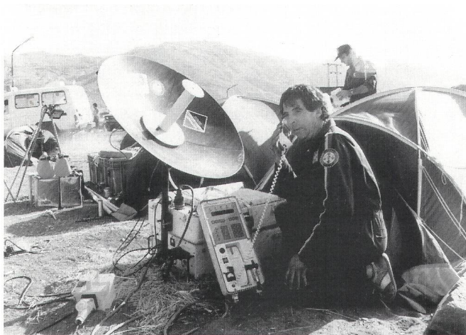
Fig. 6 Equipement INMARSAT A transportable pour utilisation mobile dans le terrain – Un appareil INMARSAT transportable per l'impiego mobile terrestre
