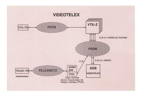
Fig. 4 Datenfluss und Netzaufbau für Videotelex
