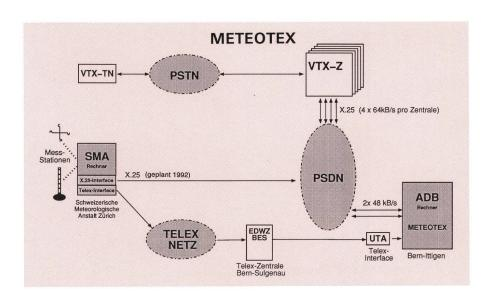
Fig. 6 Datenfluss und Netzaufbau für Meteotex
