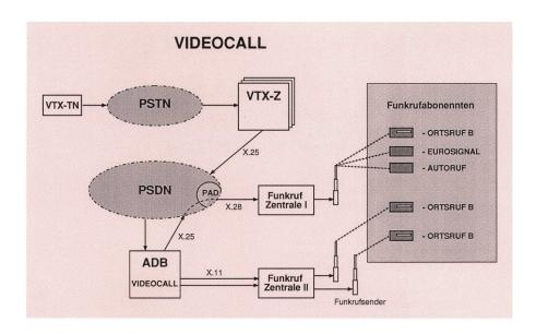
Fig. 3 Datenfluss und Netzaufbau für Videocall
