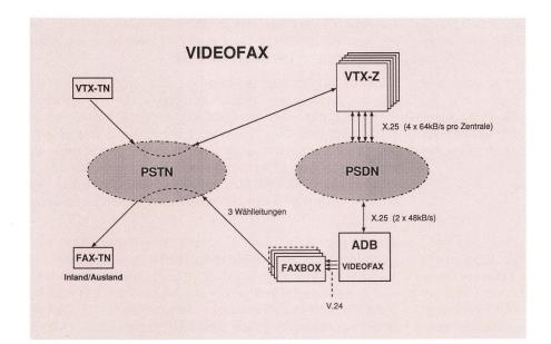
Fig. 5 Datenfluss und Netzaufbau für Videofax
