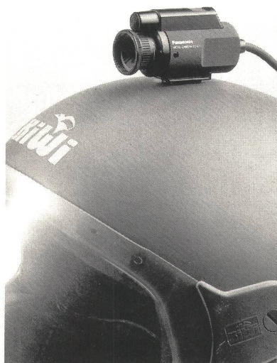
Fig. 9 Mikrokamera von Panasonic Mit 1/2"-CCD-Bildwandler, als Zubehör zu tragbarem Videorecorder erhältlich
