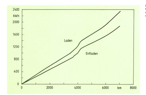
Fig. 6 Fahrversuche: Zugeführte und entnommene Energie in kWh über die Fahrstrecke
