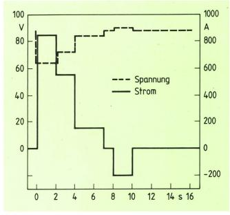
Fig. 7 Anwendung der Batterie in einem Gabelstapler. Typischer Belastungszyklus für das Arbeitsspiel Fahren, Heben, Bremsen
