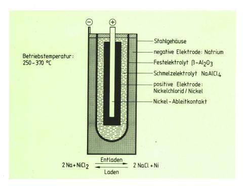
Fig. 1a Schematische Darstellung einer Natrium/Nickelchlorid-Zelle
