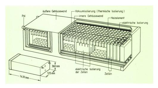
Fig. 2 Aufbau der Natrium/Nickelchlorid-Batterie
