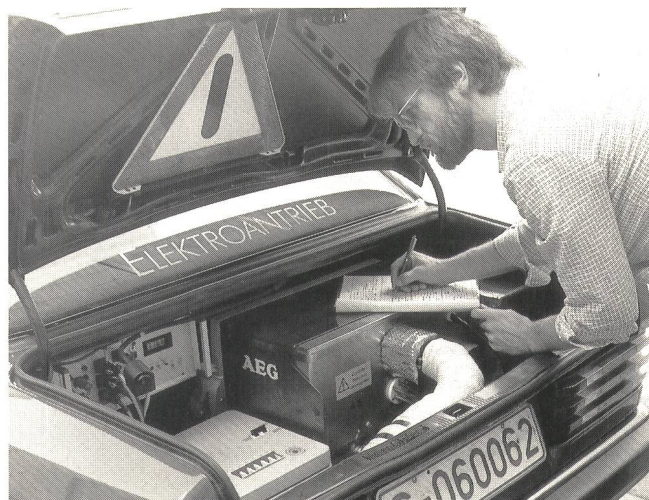
Fig. 4 Im Versuchswagen eingebaute Batterie und Messgeräte
