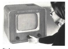
Fig. 1 ALDEPA-Fernsehempfänger von 1953 (*Al*biswerk-*De*so-*Pa*illard), Bilddiagonale 36 cm, ein einziger, festeingestellter Kanal
