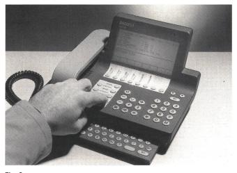
Fig. 9 L'Ascotel Crystal è un terminale adatto all'ISDN. Ad ogni impianto possono essere allacciati uno o due apparecchi di commutazione attraverso il bus S a quattro conduttori. L'apparecchio svolge la funzione di commutatore e serve da apparecchio per la programmazione. Sono previste altre possibilità d'impiego
