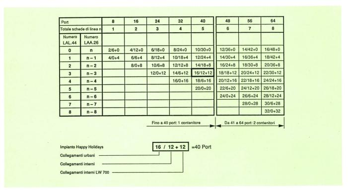
Fig. 3 L'ICU Ascotel BCS 64 è ampliabile a tappe di 8 port: la ditta Happy Holidays può crescere ulteriormente
