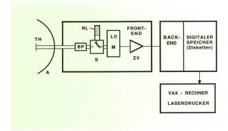
Fig. 1 Blockschema des Radiometers
