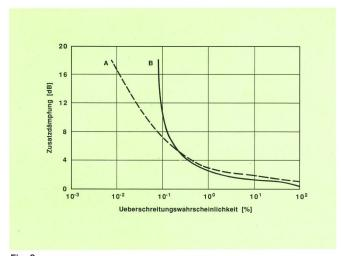
Fig. 3 Überschreitungswahrscheinlichkeit der Zusatzdämpfung Messintervall: 23. 5. 1986 bis 3. 5. 1989
