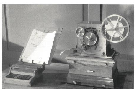
Baudot-Mehrfachtypendruckapparat, Sende- und Empfangsstation, um 1870 – Appareil télégraphique Baudot à transmission multiple imprimant les signaux en caractères typographiques, station d'émission et de réception
