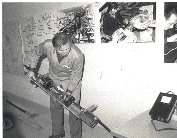
Fig. 5 Kabelmuffe für Glasfaserverbindungen
