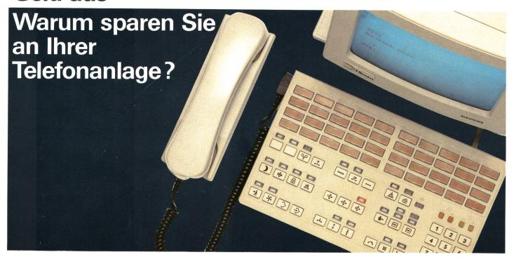
Im Zentrum aller Telefonanrufe, das Vermittlungsterminal von Hicom! Mit Bildschirm zur Information der Telefonistin über anstehende Anrufe. Einfache Vermittlungsprozeduren, komfortable Bedienerführung. 40 programmierbare Namentasten. Das ISDN-Kommunikationssystem Hicom 300 erlaubt die Nutzung der Mischkommunikation, das heisst: Sprache, Text, Bild und Daten werden über ein einziges Leitungsnetz und über eine einzige Kommunikationsnummer übermittelt.
