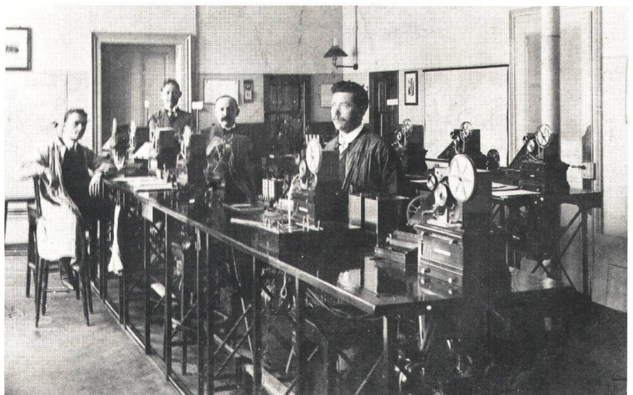
Bureau du télégraphe à Bâle en 1913. Groupe des appareils Baudot de la liaison Zurich–Bâle–Berlin (connexion en cascade)
