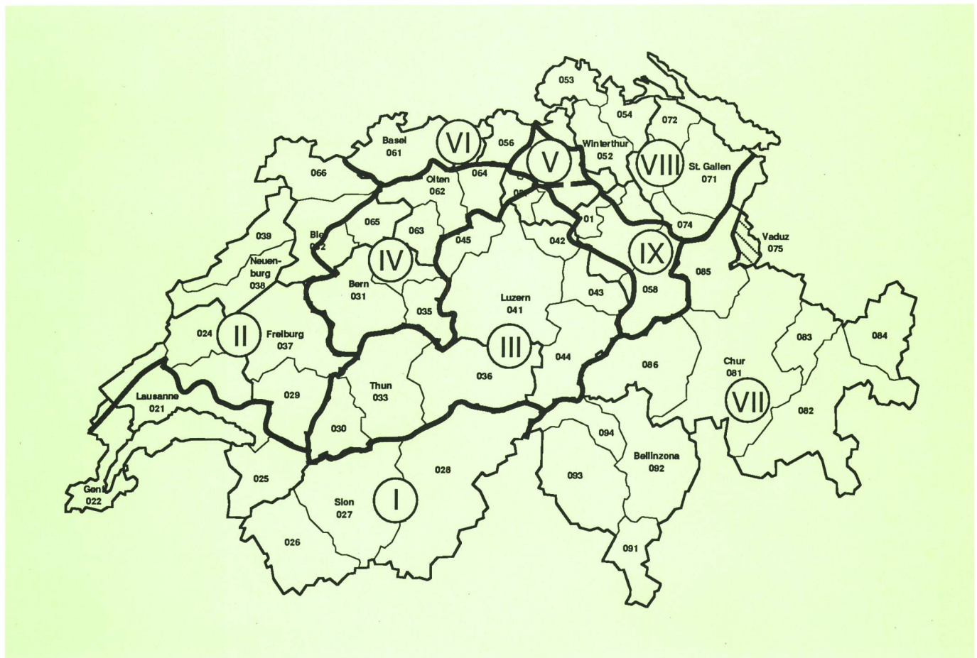
Fig. 3 Neue Teilnetzgrenzen für neun MTX – Nouvelles limites des réseaux partiels pour neuf centraux MTX — Teilnetzgrenzen – Limites des réseaux partiels
