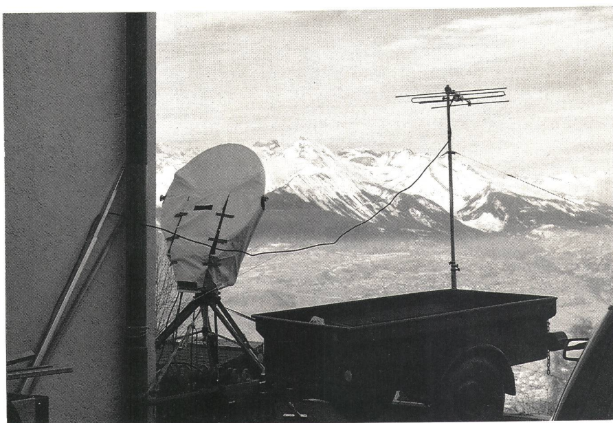
Terminal d'une liaison de secours à faisceaux hertziens entre Sion et Nendaz
