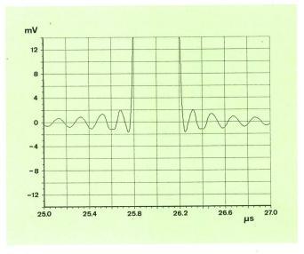
Fig. 18 Zeitapproximierter 2T-Impuls (s = 1,2) nach Abschneiden der spektralen Anteile oberhalb  $5\,\mathrm{MHz}$
