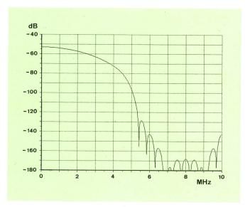
Fig. 20 Frequenzapproximierter 2T-Impuls im Frequenzbereich (s = 1,2, n = 10)
