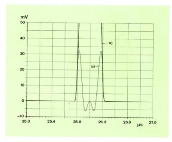
Fig. 15 Ursachen der Signalverformung beim 2T-Impuls
