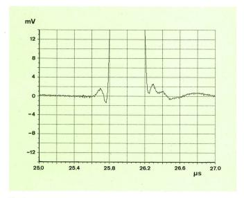
Fig. 9 2T-Impuls eines Testsignalgenerators (gemessen mit digitalem Oszilloskop)
