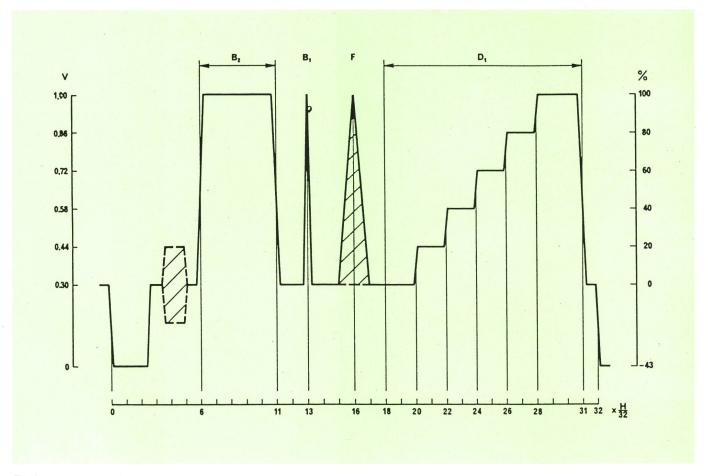
Fig. 1 CCIR-Prüfzeilensignal in Zeile 17
