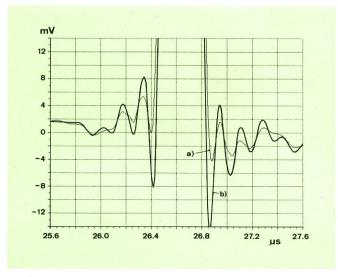
Fig. 10 2T-Impuls nach Videofilter (gerechnet mit FFT)
