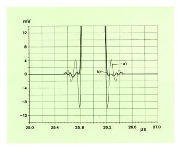
Fig. 6 Interpolierter cos²-Impuls bei unterschiedlichem Abtastraster a) Abtastfrequenz = 16 MHz,  $\tau$  = 0 ns
