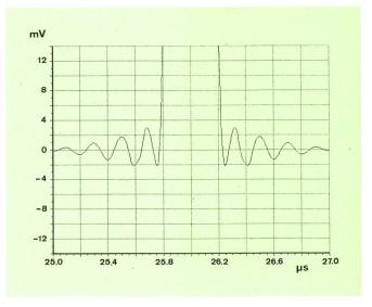
Fig. 22 Frequenzapproximierter 2T-Impuls (s = 1,2, n = 10) nach Abschneiden der spektralen Anteile oberhalb  $5\,\mathrm{MHz}$
