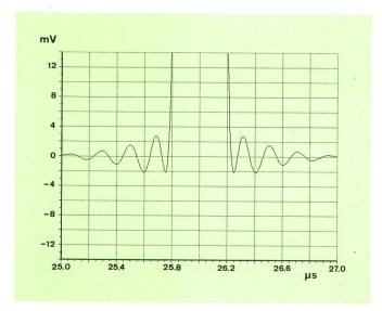
Fig. 19 Frequenzapproximierter 2T-Impuls im Zeitbereich (s = 1,2, n = 10)
