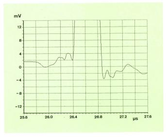
Fig. 17 Zeitapproximierter 2T-Impuls (s = 1,2) nach Videofilter (Fig. 8)
