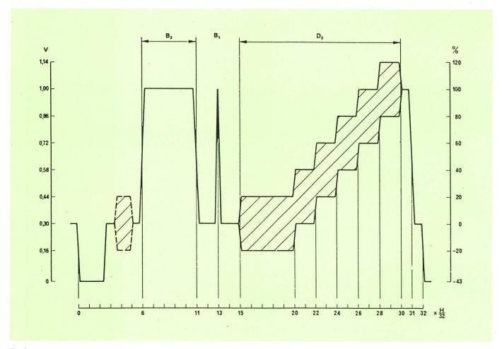
Fig. 3 CCIR-Prüfzeilensignal in Zeile 330
