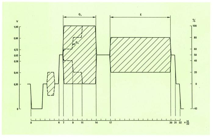
Fig. 4 CCIR-Prüfzeilensignal in Zeile 331
