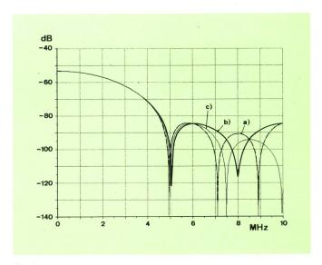
Fig. 7 Spektrum des cos²-Impulses bei unterschiedlichem Abtastraster und unterschiedlicher Abtastfrequenz
