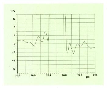
Fig. 21 Frequenzapproximierter 2T-Impuls (s = 1,2, n = 10) nach Videofilter (Fig. 8)
