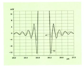
Fig. 11 2T-Impuls nach Abschneiden oberhalb 5 MHz (gerechnet mit FFT)
