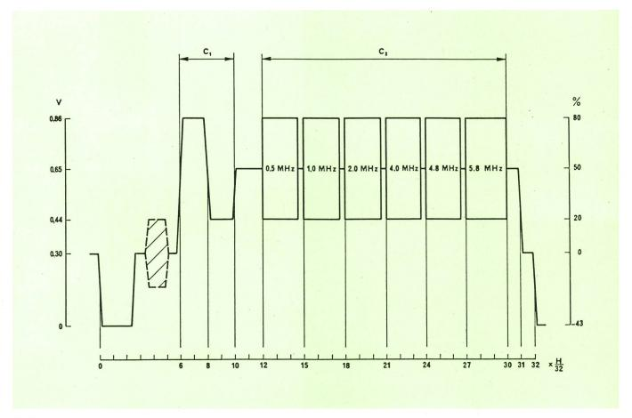
Fig. 2 CCIR-Prüfzeilensignal in Zeile 18
