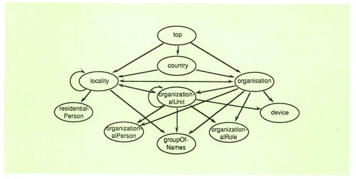
Fig. 3 Eine mögliche DIT-Struktur
