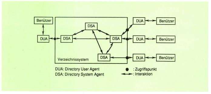
Fig. 5 Komponenten des Verzeichnissystems
