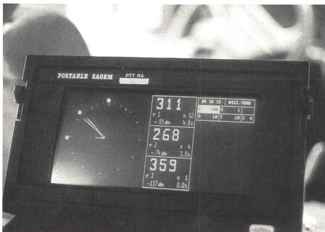
Fig. 4 Bildschirm des Peilers TRC 296 D
