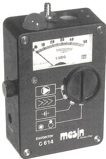
Fig. 1 Gaswarngerät Exotector G 614 ohne Lederschutztasche – Détecteur de gaz Exotector G 614 sans étui de protection en cuir Die Bedeutung der Symbole am Betriebsartenschalter und die Benennung der einzelnen Teile sind auf der Kurzbetriebsanleitung (Anhang) angegeben. La signification des symboles du commutateur d'exploitation et la désignation des différents éléments sont indiqués dans le mode d'emploi succinct (Annexe)
