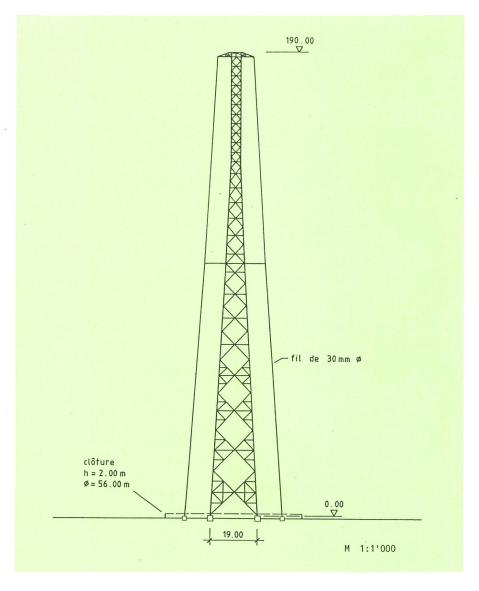
Fig. 3 Nouvelle antenne en jupe, constituée de six fils supportés par un mât de 190 m de hauteur
