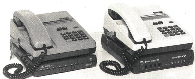
Fig. 6 Teilnehmerseitiges DOV-Modem, links das Gerät von Ascom Auto-phon, rechts jenes der Firma Datentechnik
