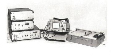
Fig. 1 Messplatz mit Oszilloskop, OTDR, XY-Recorder, Dämpfungsmessplatz, verwendet bis etwa 1985
