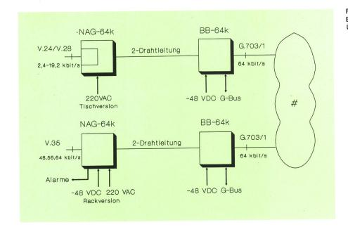
Fig. 12 Einsatzfälle für den Anschluss an das digitale Übertragungsnetz
