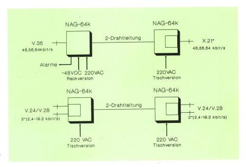
Fig. 13 Einsatzfälle für Punkt-Punkt-Verbindungen im Ortsnetz
