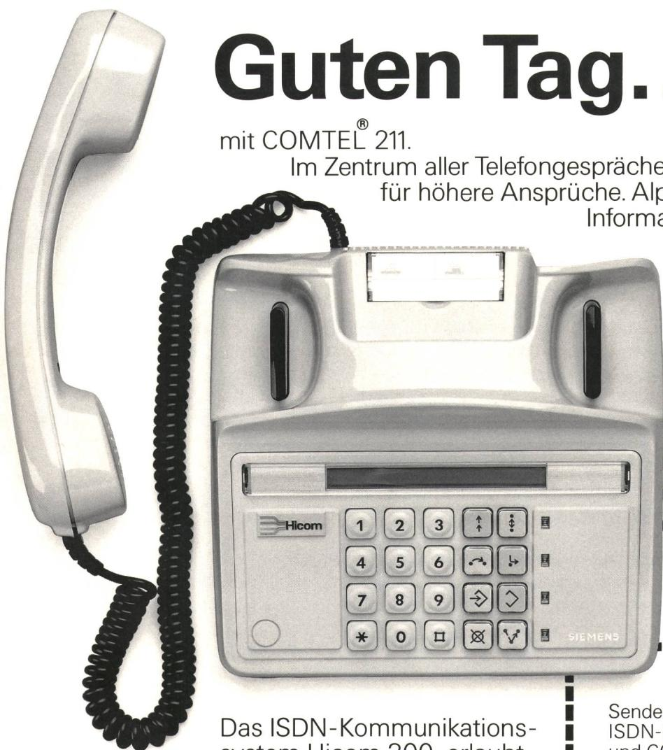
Das ISDN-Kommunikationssystem Hicom 300, erlaubt die Nutzung der Mischkommunikation, das heisst: Sprache, Text, Bild und Daten werden über ein einziges Leitungsnetz und über eine einzige Kommunikationsnummer übermittelt.
