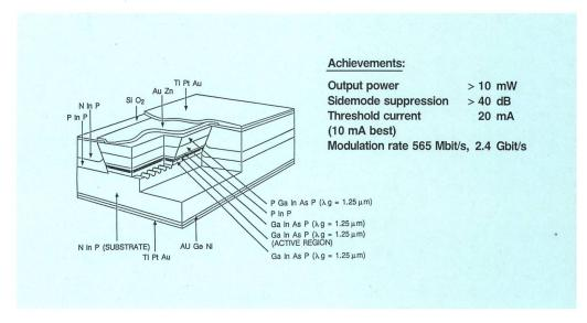
Fig. 9 Distributed Feedback (DFB) Laser Wellenlänge 1500 nm
