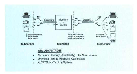
Fig. 12 Künftige integrierte Breitbandnetze, basierend auf dem «Asynchronous Transfer Mode» (ATM)
