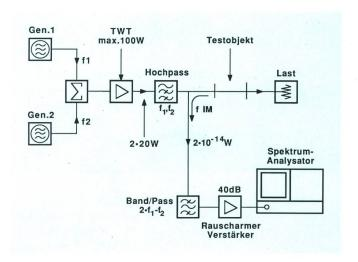
Fig. 2 Grundschaltung zur Intermodulationsmessung
