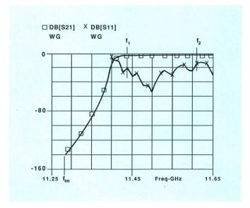
Fig. 7 Hochpass-Filter, Transmission und Reflexion
