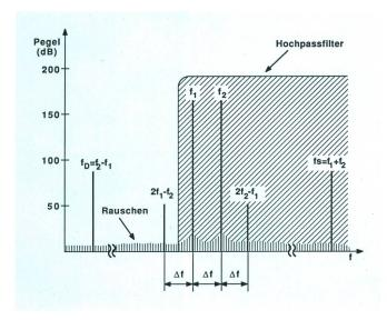
Fig. 1 Verhältnisse bei Intermodulation
